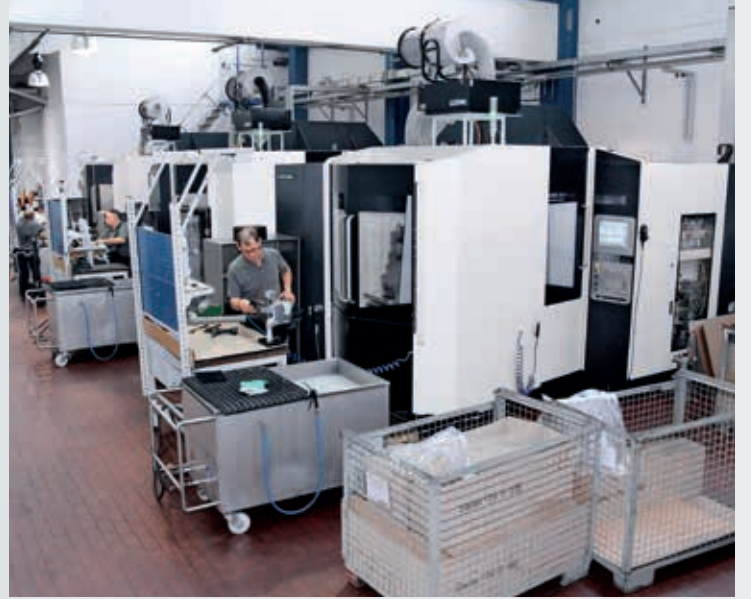
ZBG'de üç adet yeni DMC 60 H linear tezgah, en kısa zamanda ve en yüksek kaliteli zorlu motosiklet parçalarını işliyor.
