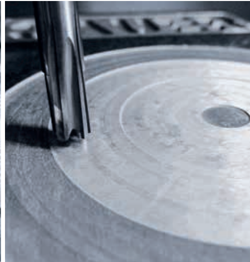
Kenar talaşlanması, fiber aşınması ya da delaminasyon olmaksızın cfrp'nin düzenlenmesi ve shafting.
