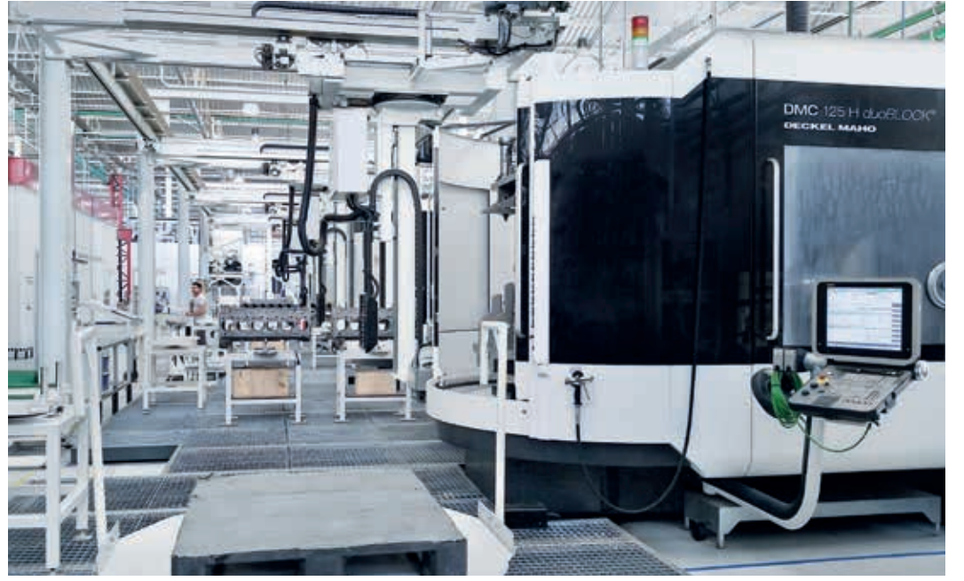
DMG MORI Sistemleri, FPT Industrial Argentina S.A. firması için anahtar teslim proje olarak 13 adet DMG işleme merkezinden oluşan bir üretim hattı tasarladı.
