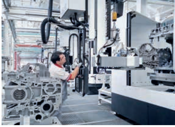
Parçalar ayar istasyonunda yüklenir. Tornalama istasyonu öndedir.
