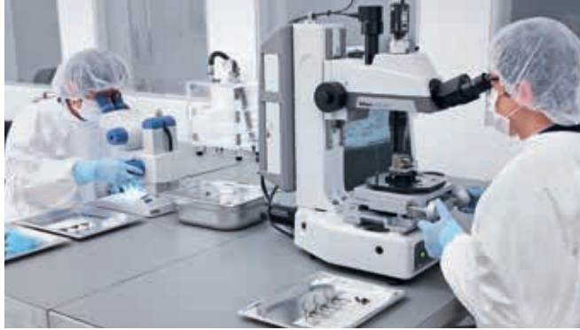
Şimdi Wernau'da: Mikroskopa tam olarak 2 µm'ye MR sensor ayarlama.
