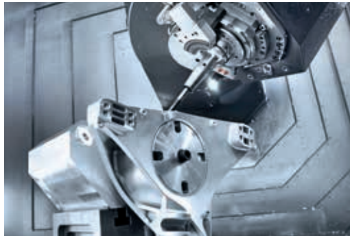
toolcraft, oldukça doğru ve verimli 5 eksenli işlemeyle bu tekerlek rulmanı gibi karmaşık hassas parçaları üretir.
