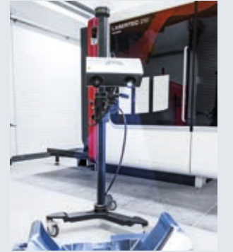
3D tarayıcı kullanılarak takım geometrisi ölçülmesi.
