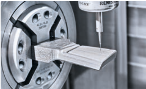
NTX 1000 üzerinde bıçak eklerinin silindirik soyma freze için 5-eksenli işleme.
