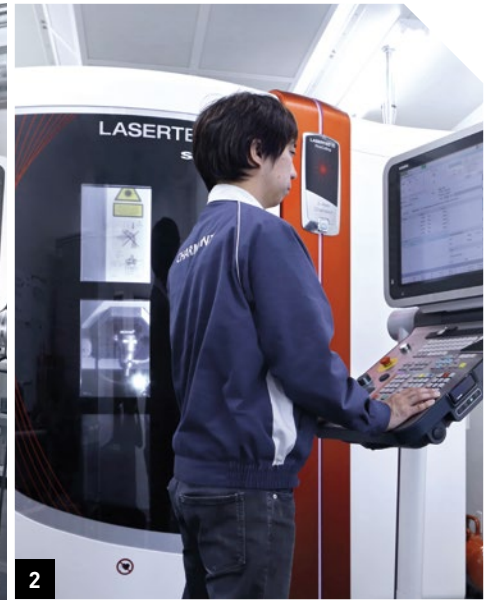
1. Soldan sağa: Yuki Kataoka (mühendis), Kazuo Iwahori (genel müdür) ve Terukazu Mizuguchi (mühendis) yüksek hızlı işleme ünitesi HSC 20 linear'ın önünde. Arka planda ULTRASONIC 20 linear görülmüyor. 2. LASERTEC 20 FineCutting ile yapılan 5 eksenli lazerli kesim hassaslık taleplerinin yüksek olmasından dolayı sıcaklık kontrollü bir odada yapılıyor.
