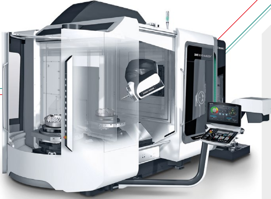
DMC 80 FD duoBLOCK Freze-torna komple işleminde maksimum üretim verimi sayesinde palet değiştiricisiyle dikkat çekiyor.
